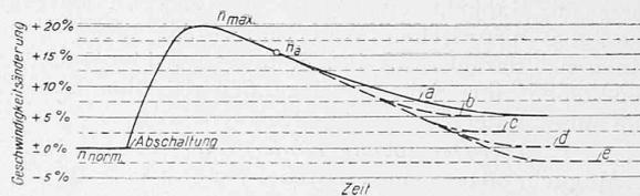
Abb. 21. Geschwindigkeitsänderung während der Rückführung des Reglers.
