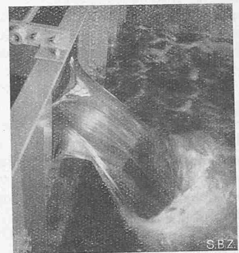
Abb. 13. Ueberfallwehr, hergerichtet für Ueberfall mit Seitenkontraktion.
