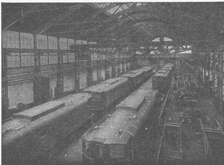
Lokomotiv-Montagehalle mit elektrischen Lokomotiven für Südafrika
