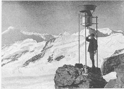
Abb. 1. Hochgebirgs-Niederschlagsammler auf dem Mönch-Grat, 3800 m ü. M., Blick gegen SSW..
