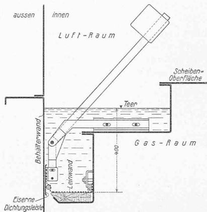
Abb. 3. Schnitt durch die Teertasse. — 1 : 15.
