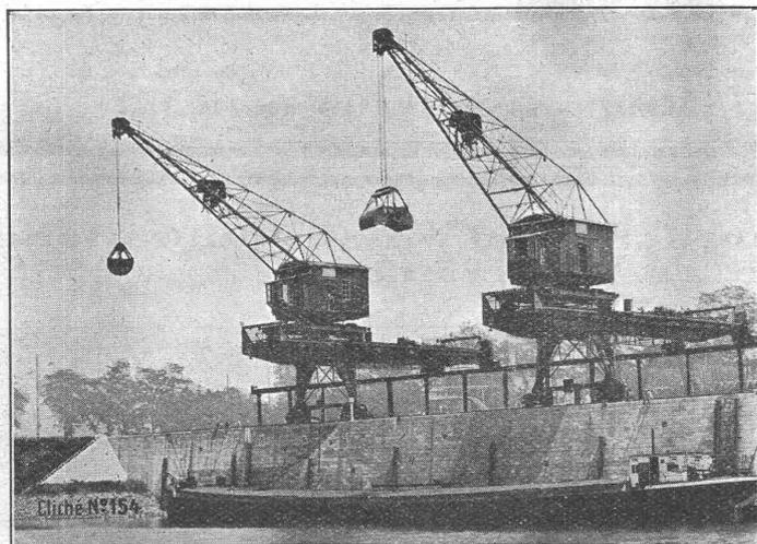
Hafenkrane für Greifer- und Stückgutbetrieb.
