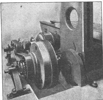
Hobelmaschinen-Einzelantrieb mit elektro-
