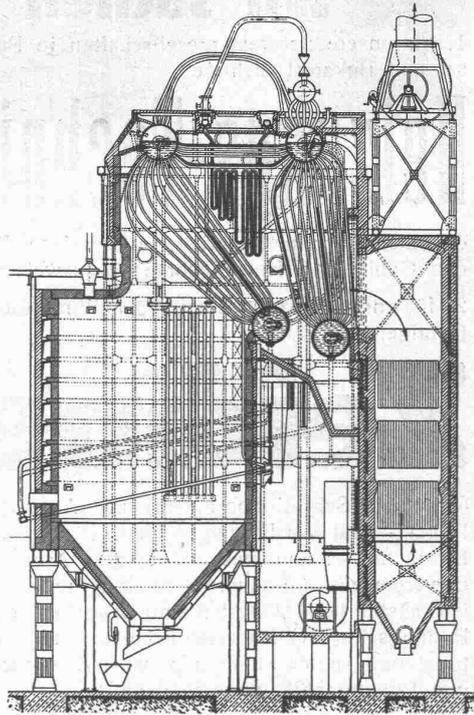
Sulzer-Kesselanlage mit Kohlenstaubfeuerung
