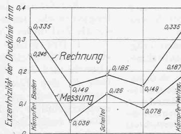
Abb. 7. Errechnete und gemessene Exzentrizitäten der Drucklinie.
