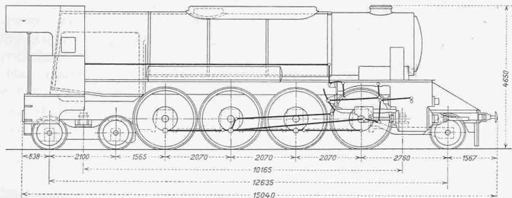
Typenskizze der österreichischen 1D2 Schnellzuglokomotive. — Masstab 1 : 150.
