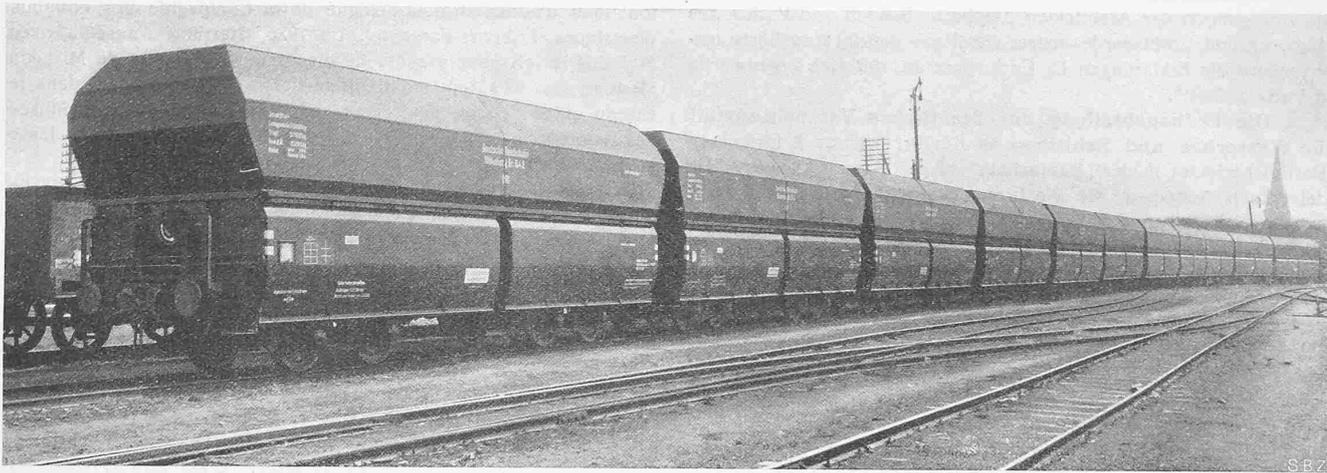
Abb. 1. Deutsche Grossgüterwagen der neuen Einheitsbauart für Koks mit 92 m<sup>3</sup> Fassungsvermögen, gebaut von der Friedr. Krupp A.-G., Essen.
