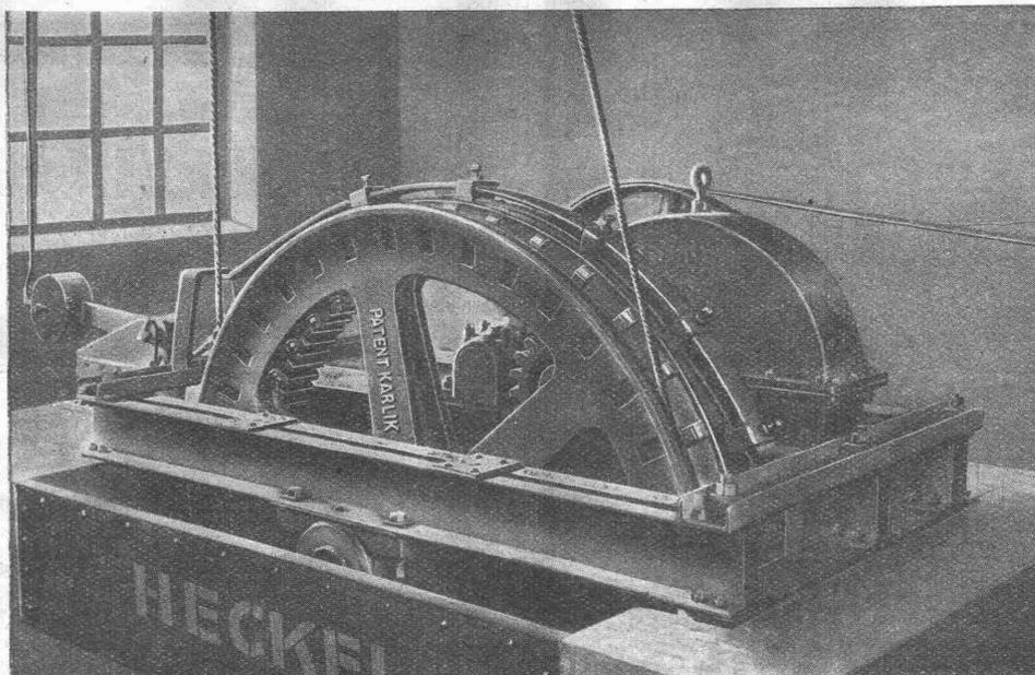
Antrieb einer Drahtseilbahn-Heckel für 100 t/Std. Leistung mit Karlikscheibe
