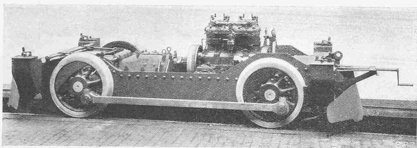
Abb. 3. Triebgestell mit eingebautem Motor und Getriebe.
