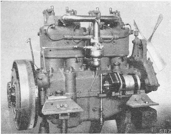
Abb. 4. Vierzylinder Benzin-Triebmotor von 100 PS, 1200 Uml/min.
