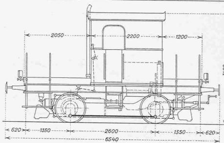
Abb. 2. Typenskizze der Lokomotive. — 1 : 100.
