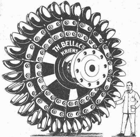
Lauftrad einer der vier 17000 PS Pelton-Turbinen
