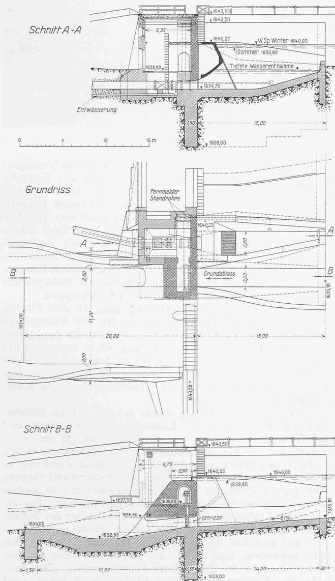
Abb. 75. Staumauer und Wasserfassung am Schlappinbach. — 1:400.
