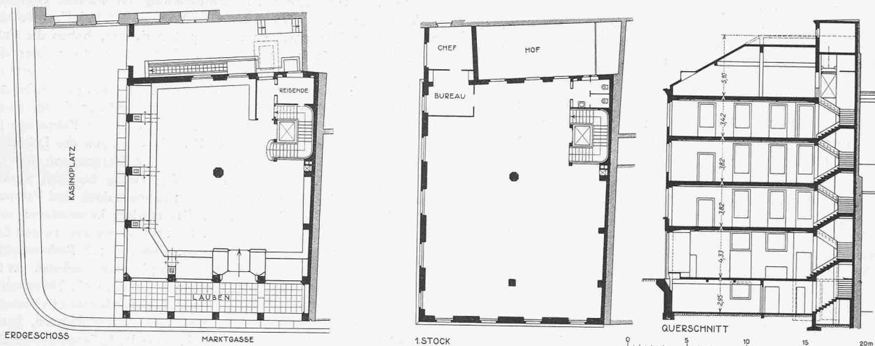
Abb. 2. Geschäftshaus Wiegner, Winterthur. Grundrisse vom Erdgeschoss und I. Stock, und Querschnitt. — Masstab 1 : 400.
