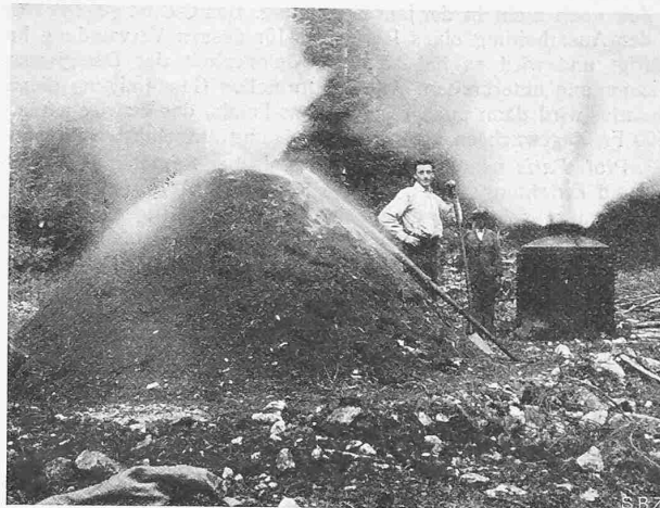
Abb. 4. Vergleichsversuche mit Meiler und tragbarem Ofen.
