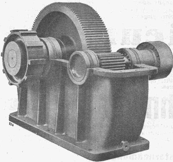
Reduktions-Getriebe für den Antrieb einer Cement-Mühle,
