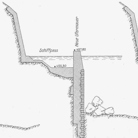
Abb. 3. Neue Uferschutzmauer.
