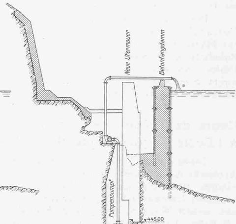
Abb. 4. Abschluss der Baugrube. — 1 : 300.
