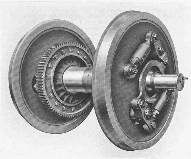
Abb. 2. Triebbradsatz mit Zahnrad, Hohlwelle und Federkupplung.
