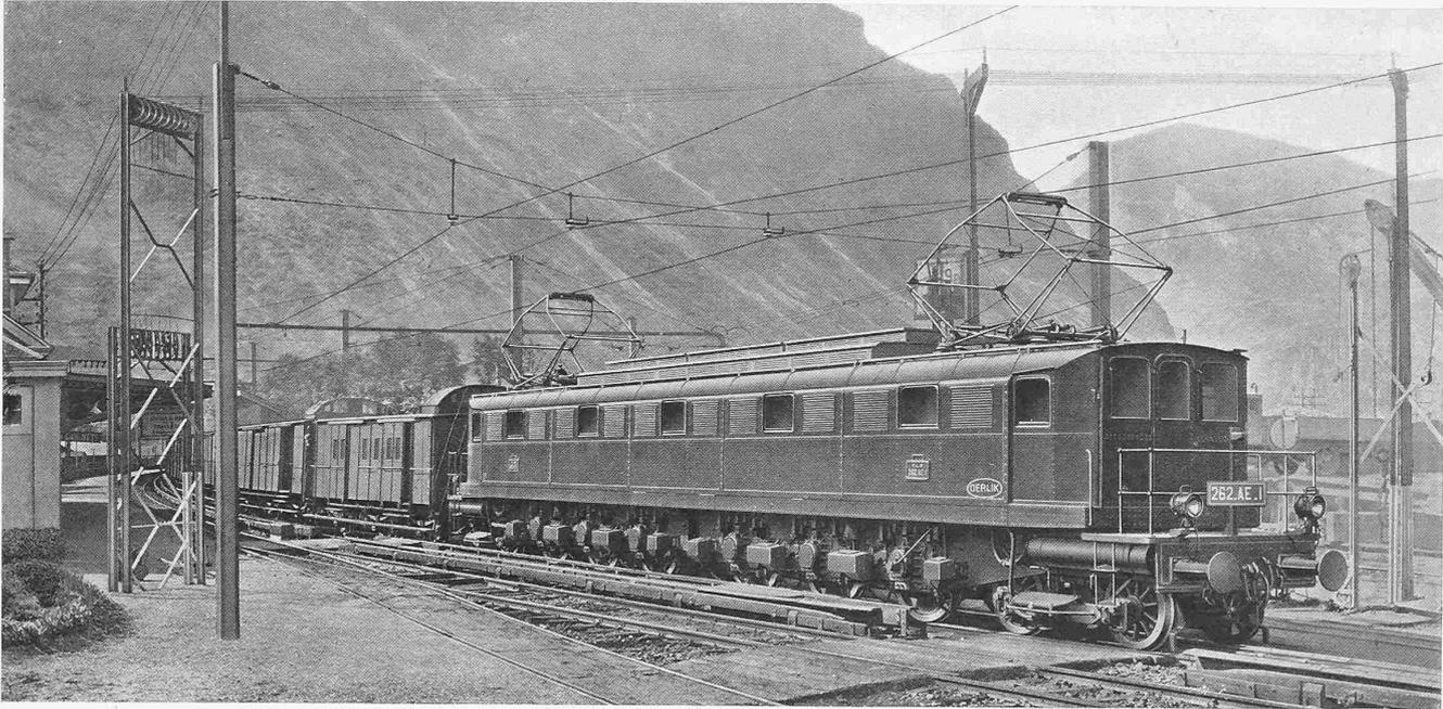
Abb. 1. Die 2C<sub>0</sub>C<sub>0</sub>-2-Schnellzugslokomotive von 5400 PS Einstundenleistung der P. L. M. im Bahnhof St. Jean-de-Maurienne.
