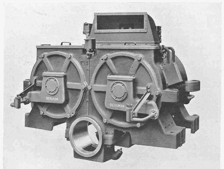
Abb. 4. Doppelmotor von 2 x 450 PS Einstundenleistung.
