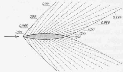
Abb. 15. Rechnerisch bestimmtes Wellenbild für einen Profildraht.
