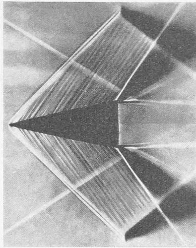
Abb. 14. Bild der Strömung gegen einen Keil.
