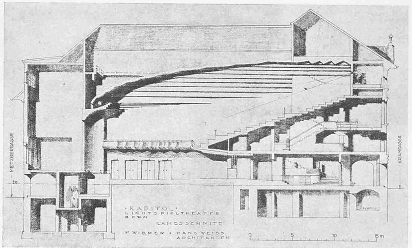
Abb. 3. Längsschnitt durch das Kapitel-Lichtspieltheater in Bern. — Masstab 1 : 400.
