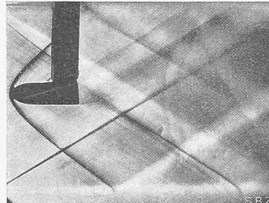
Abb. 17. Infanteriegeschoss alter Form im Luftstrom bei Uberschallgeschwindigkeit.
