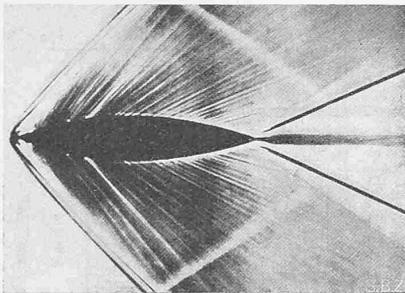
Abb. 16. Schlierenbild der Uberschallströmung gegen einen Profildraht.
