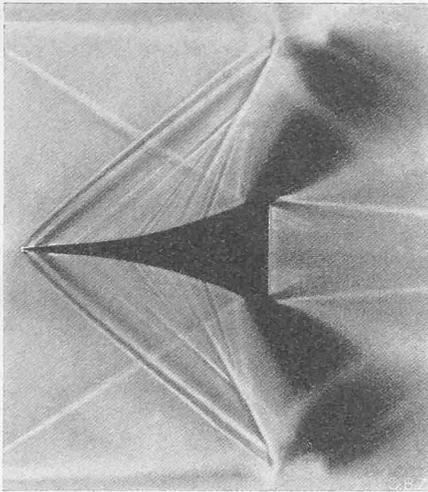
Abb. 13. Schlierenbild der Kompressionsströmung.
