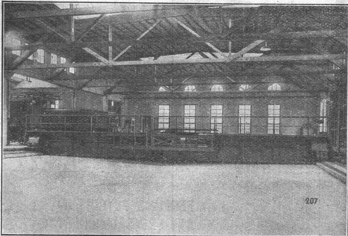
Elektrische Schiebebühne, 150 t Tragkraft, 20 m Länge,
