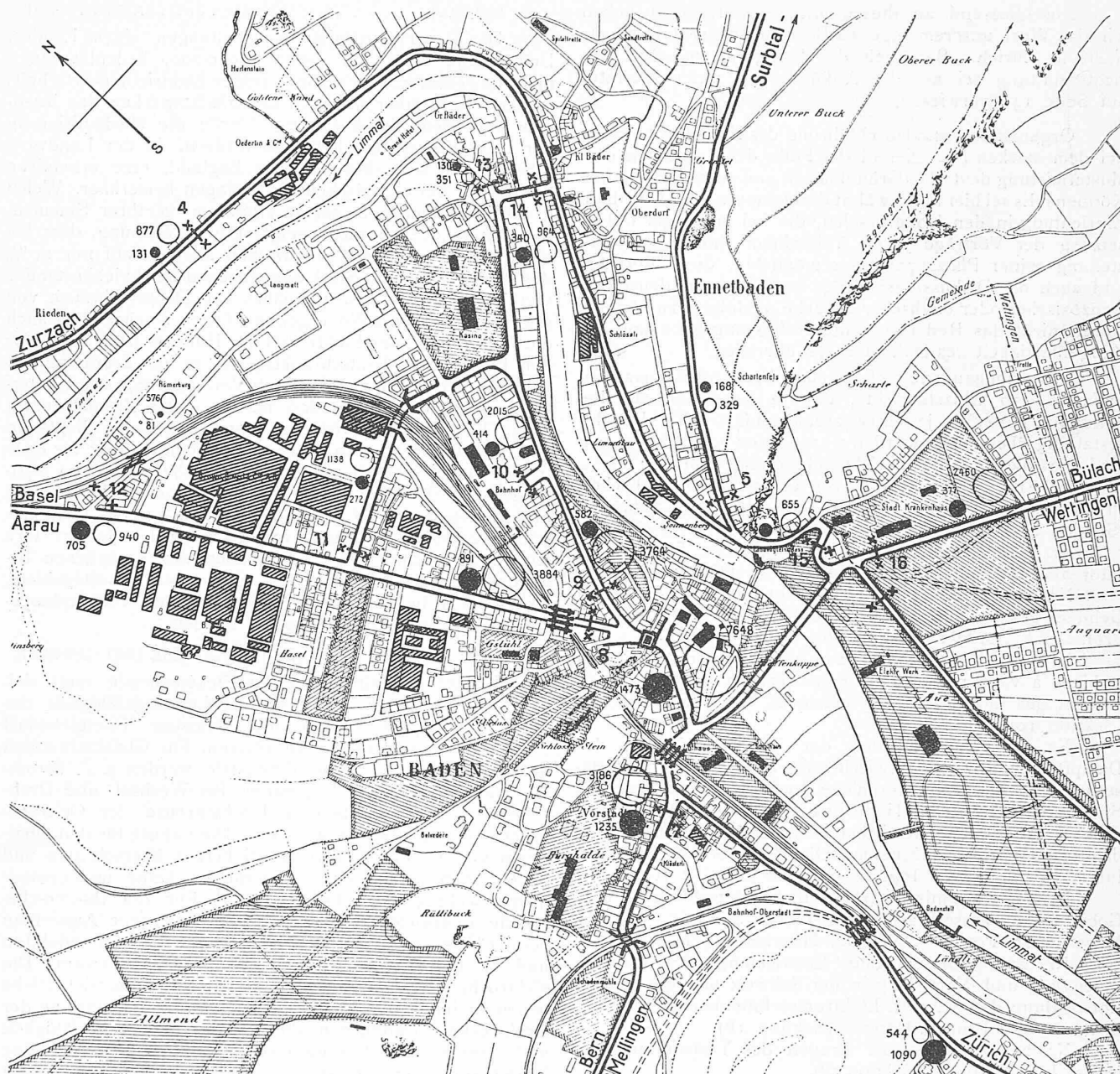
Verkehrsplan der Stadt Baden und Umgebung, Masstab 1:10000. — Die vorhandenen Niveau-Uebergänge sind als Gitter eingezeichnet; die Zahlen bei den vollen Kreisen bezeichnen die Anzahl Personen- und Last-Automobile, jene bei den leeren Kreisen die Anzahl Fahr- und Motorräder, die am 25. November 1929 zwischen 6 30 und 7 30 h an den Stellen x—x gezählt worden sind. Der starke Fahräderverkehr rührt von den vorwiegend im Süden der Stadt wohnenden Arbeitern und Angestellten her.
