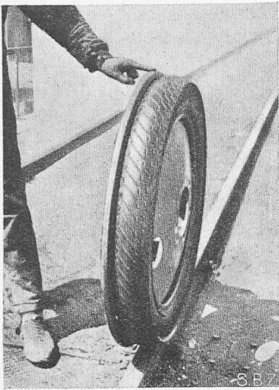
Abb. 2. Michelin-Gummireifen für Schienenfahrzeuge.
