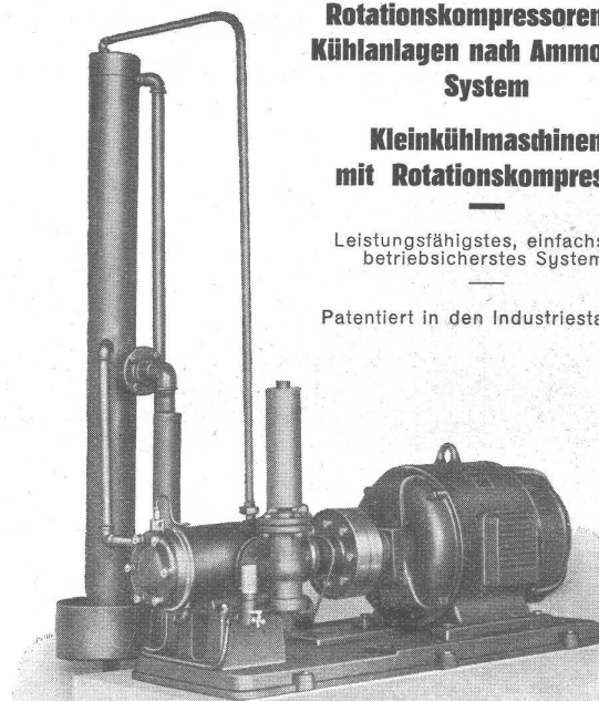
Zweistufiger, einzylindriger Rotationskompressor für 6 bis 8 at Druck.
