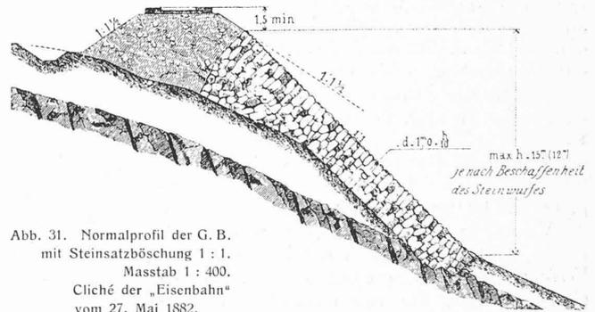
Abb. 31. Normalprofil der G. B. mit Steinsatzböschung 1 : 1,5. Masstab 1 : 400. Cliché der „Eisenbahn“ vom 27. Mai 1882, auch als Beispiel unserer Darstellungsart vor 50 Jahren.
