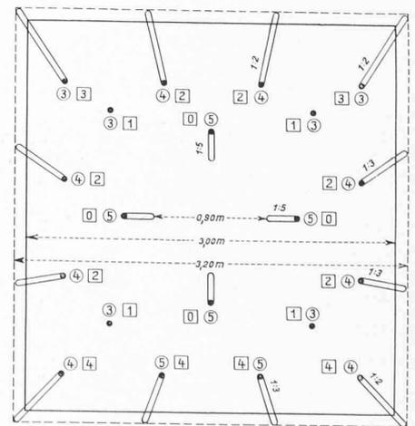
Abb. 42. Bohrlochverteilung, Minendosierung, Tempierung.
