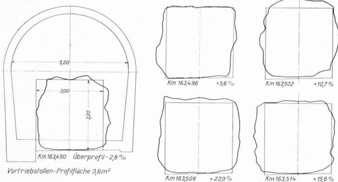
Abb. 43. Normal- und Ueberprofile, mit dem Pantographen (1 : 20) aufgenommen. — 1 : 150.
