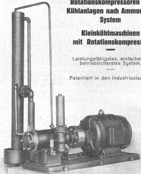
Zweistufiger, einzylindriger Rotationskompressor für 6 bis 8 at Druck.
