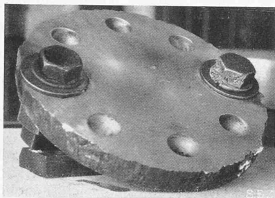
Abb. 1. Erosion an Schrauben durch Tropfenschlag.
