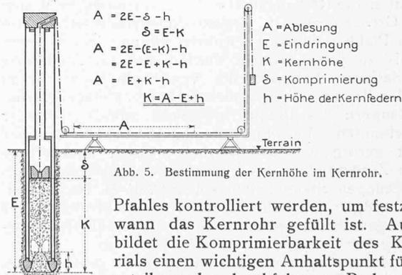
Abb. 5. Bestimmung der Kernhöhe im Kernrohr.
