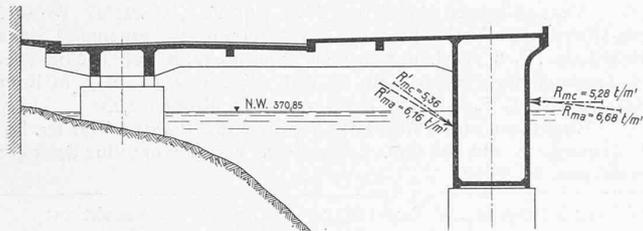
Abb. 18. Vergleich der Mittelwerte der Resultierenden auf den Schwimmkasten bei verschiedenen Massen des Modells für Wellen von 25 m L. u. 1,50 m H. bei N.W.  $R_{mc}$  und  $R_{ma}$  erhalten aus Versuchen mit dem ganzen Modell.  $R_{lc}$  und  $R_{la}$  erhalten aus Versuchen mit dem Schwimmkasten allein.
