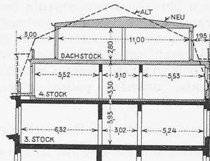
Abb. 3. Schnitt 1 : 400 durch die neu aufgebauten Obergeschosse.
