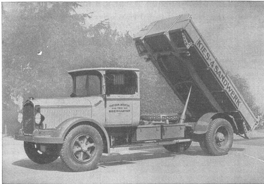
Für grosse Erdaushübe und Baumaterialtransporte sind unsere hydraulischen Dreiseitenkipper unübertroffen. Sie besitzen alle den widerstandsfähigen Berna-Ritzelantrieb mit grosshubigem Benzin- oder Rohölmotor 70 und 80 PS.
