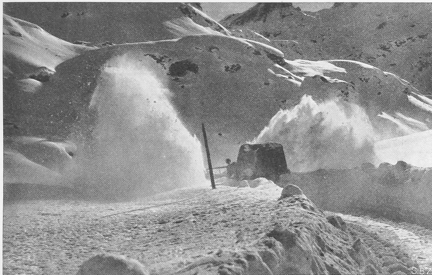
Abb. 7. „Snow-King“ mit „Cletrac“ am Julier, nach links hoch, nach rechts weit auswerfend.
