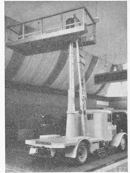
Abb. 1. Montageturmwagen der Städt. Strassenbahn Zürich, gebaut von Ad. Saurer A.-G., Arbon.
