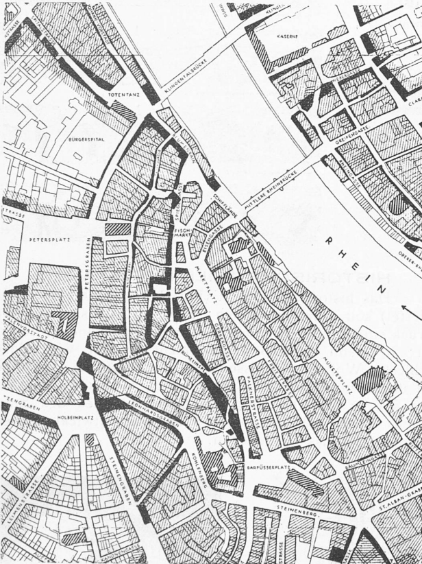
Ausschnitt 1: 10 000 aus dem Basler Stadtkorrektionsplan. Schwarz = abzubrechende Bauteile. Die Verbreiterung der aus dem Mittelalter stammenden Strassenzüge trifft eine grosse Zahl von Liegenschaften, die zudem oft eine für eine gute Ueberbauung ungünstige Form erhalten.
