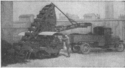
Die Einschaltung zuverlässig arbeitender Gurtförderer „RACO“, auf Raupenbänder laufender Becherwerksauf- lader oder anderer Fördergeräte, die wir als Spezialität liefern, vermag bei Steigerung der Leistungsfähigkeit die Transportkosten bedeutend zu reduzieren.
