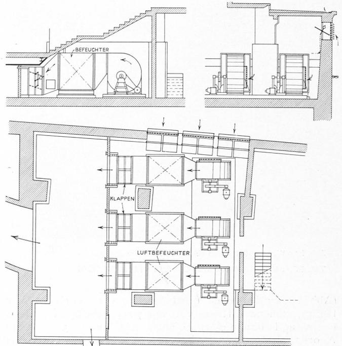
Abb. 27. Die Lüftungsanlage im Textilwarenhause OBER in Zürich. — 1:200.
