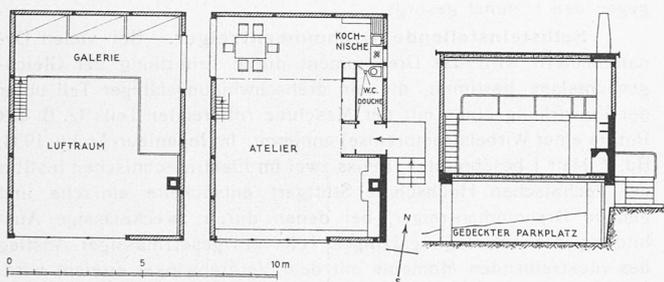
Abb. 2. Grundrisse und Schnitt. — Masstab 1 : 250.
