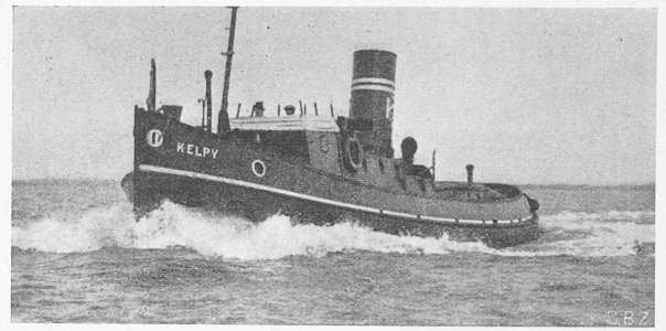
Abb. 4. Englischer Dieselschlepper mit 300 PS-Allen-Motor und „SLM-Winterthur“-Wendegetriebe.
