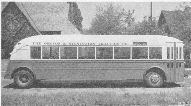
Abb. 5. Twin-Coach, 37 Sitzplätze, Heckmotor, Einsteighöhe 70 cm.
