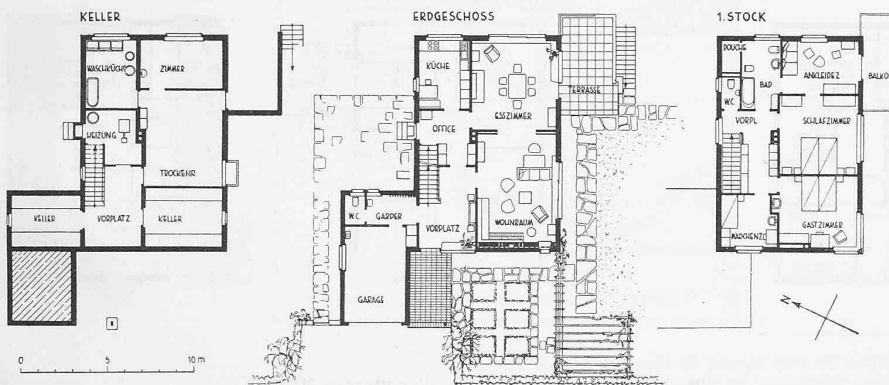
Abb. 4. Grundrisse des Hauses Kronauer. — Masstab 1 : 400.
