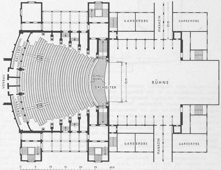
Abb. 1. Das Bayreuther Festspielhaus mit ursprünglicher Treppenanlage. Grundriss 1 : 600
