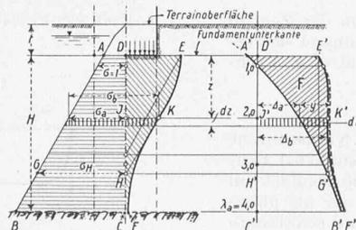
Abb. 8. Graphische Setzungsanalyse
