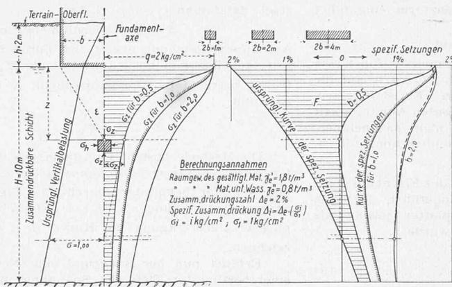
Abb. 9. Graph. Setzungsanalyse für verschiedene Breiten der Lastflächen
