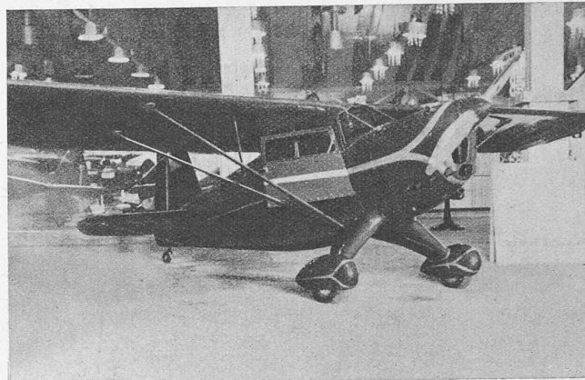
Abb. 2. Tandem-Zweisitzer Rearwin Speedster. Spannweite 9,8 m, Länge 6,7 m, 150 PS, v = 260 km/h, Steigfähigkeit 7,1 m/sec, Nutzlast 300 kg
