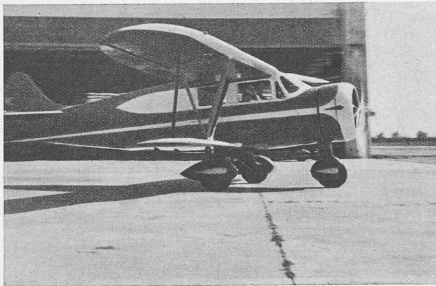
Abb. 1. Fünfplätziges Reiseflugzeug Waco N mit Bugrad, Spannweite 10,6 m, Länge 8,2 m, 300 PS, v = 250 km/h, Steigfähigkeit 4,1 m/sec, Nutzlast 620 kg
