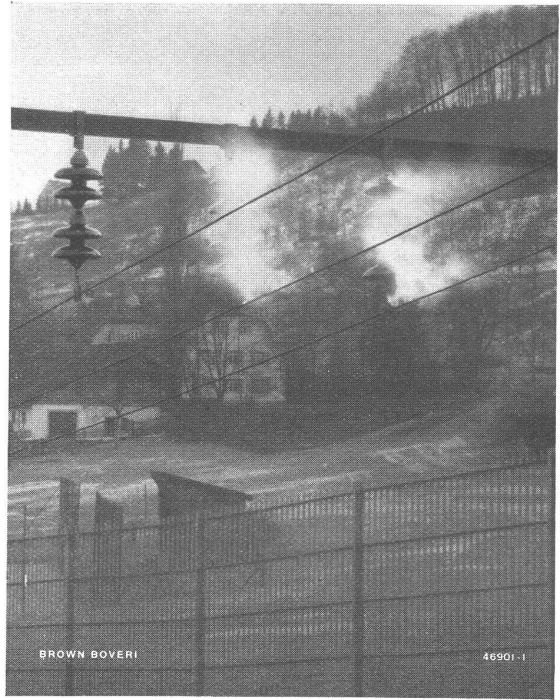
Versuchsanregung zur Bestimmung der Entionisierungszeiten von Kurzschlusslichtbogen bei Freileitungen
