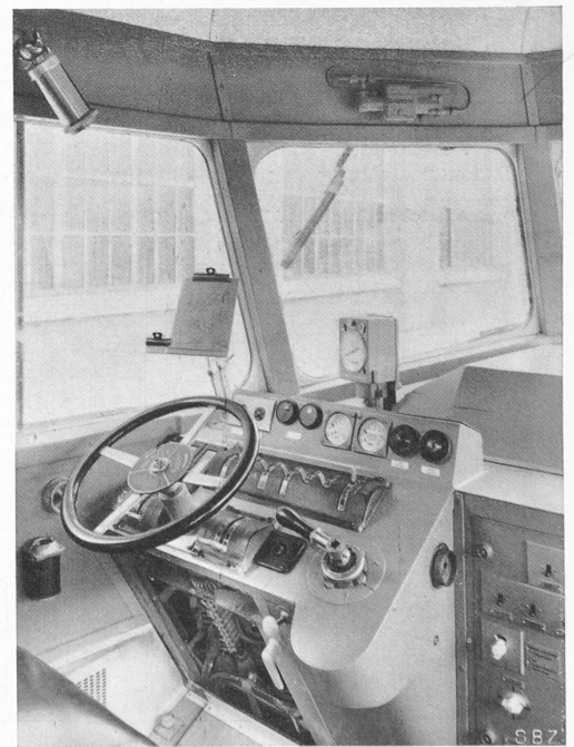
Abb. 10. Führertisch mit Steuerapparatur
