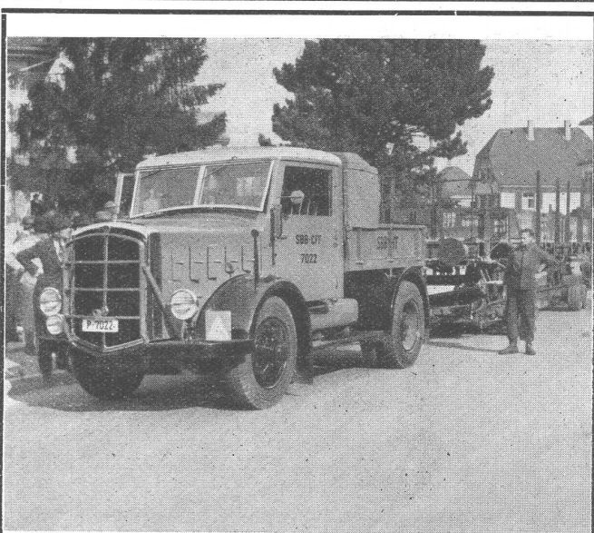
BERNA-Schlepper mit Vierrad-Antrieb mit Rollschemel zum Abschleppen von beladenen Eisenbahnwagen im Totalgewicht von 40 Tonnen
