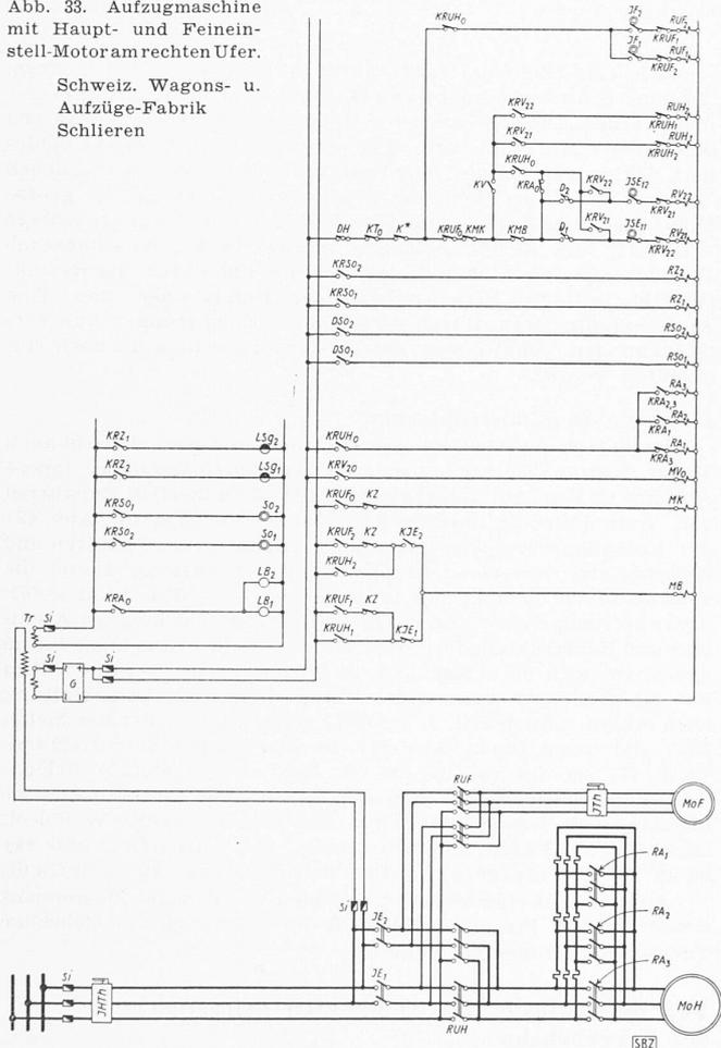
Abb. 40. Schaltschema der rechtsufrigen Schlieren-Aufzüge.
