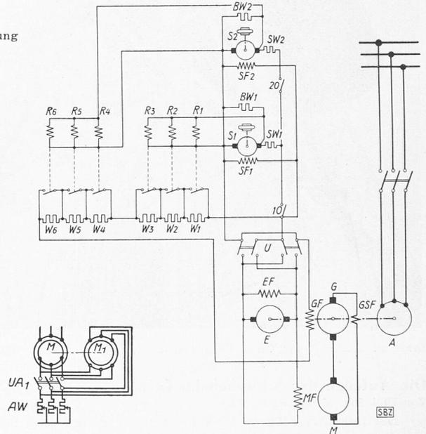
Abb. 38. Schema der Kaskaden-Schaltung
