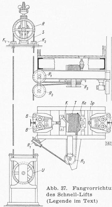
Abb. 37. Fangvorrichtung des Schnell-Lifts (Legende im Text)
