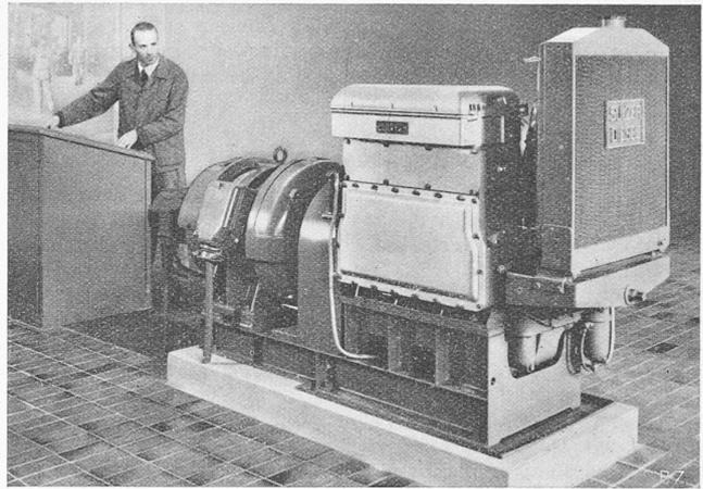
Abb. 2. Sulzer-Gegenkolben-Dieselmotor, 3 Zylinder 90 PS<sub>e</sub>, 1500 U/min mit BBC-Generator als Notstromgruppe, im Betrieb an der LA
