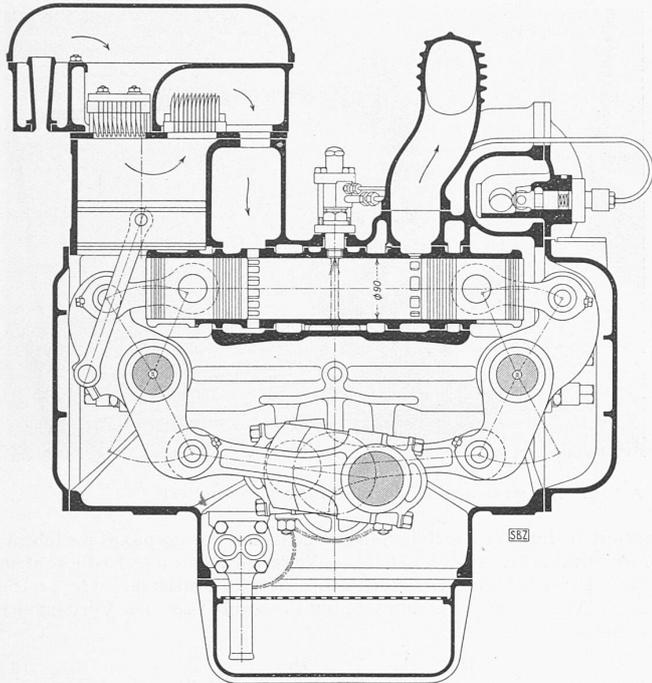
Abb. 1. Sulzer-Zweitakt-Gegenkolben-Dieselmotor, Schnitt 1 : 10
