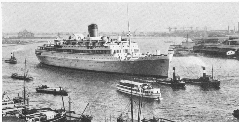
Abb. 4. Grösstes und schnellstes Dieselmotorschiff der Welt: «Oranje» Amsterdam, ausgerüstet mit insgesamt 46 500 PS e durch Gebrüder Sulzer in Winterthur (vergl. Text)
